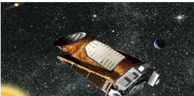
Ilustración del telescopio espacial Kepler. El telescopio está diseñado para detectar la abundancia de planetas similares a la Tierra en el trozo de cielo que observa y la situación de sus estrellas. (<http://www.elpais.com/sociedad/ciencia/>)
